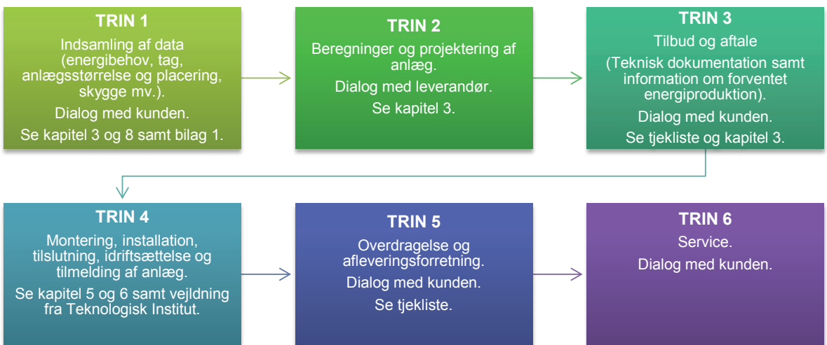
Figur 1: Flowdiagram, der viser trin fra indsamling af data til overdragelse af anlæg og eventuel service
